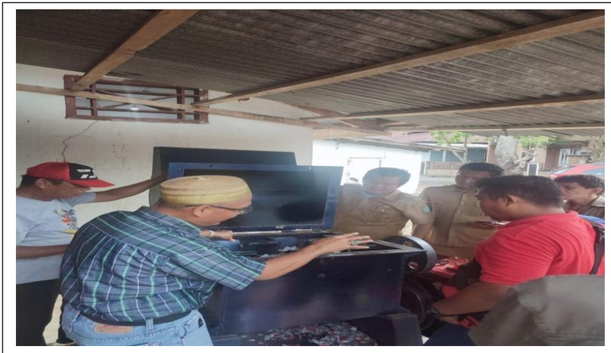
Gambar 6. Operasional mesin berjalan dengan sampah plastik menjadi cacah
