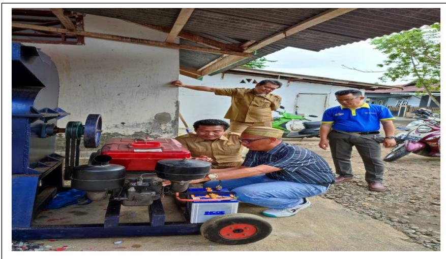
Gambar 4. Praktik Pengecekan oli dan perawatan serta persiapan penyalaan mesin
