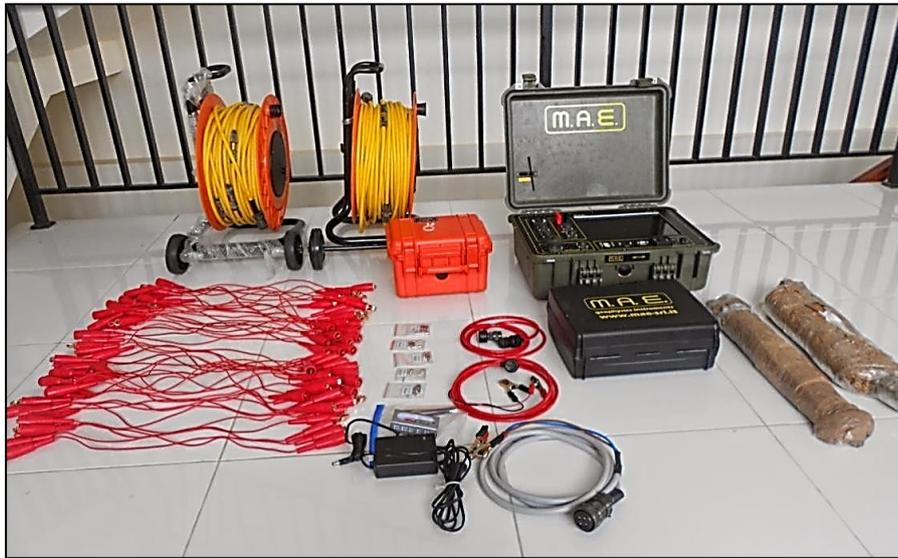
**Gambar 1.** Peralatan alat *Resistivity* dan IP meter MAE X612 – EM
