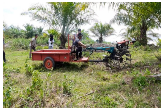
Gambar 2. Pengoperasian traktor menggunakan trailer konvensional.
