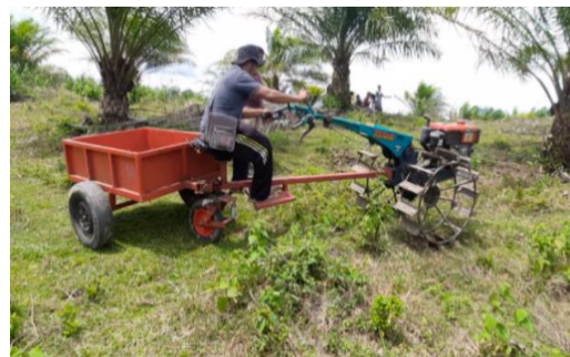
Gambar 1. Pengoperasian traktor menggunakan trailer pivot .
