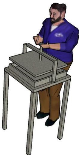
**Gambar 5.** Alat Pengepres dan Pemotong Tahu
