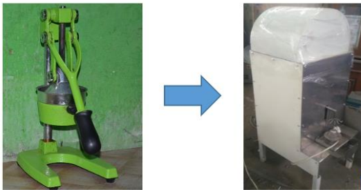
Gambar 13. Modifikasi Teknologi Pemerasan Buah Lemon Dari Semi-Mekanis Menjadi Mekanis
