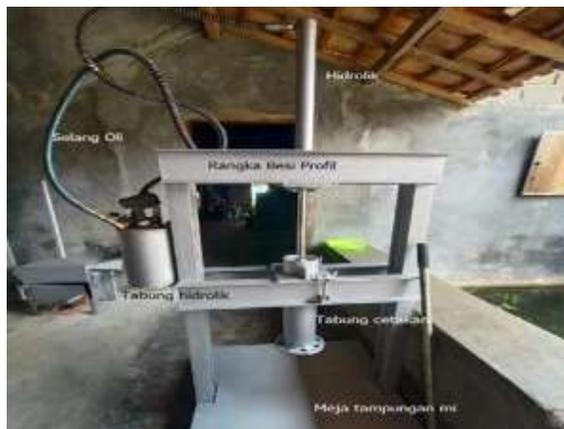
Gambar 1. Alat pencetak Mie aci singkong hidrolik
