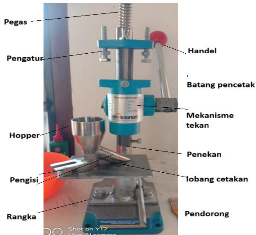
Gambar 2. Mesin pencetak kopi jenis press tekan
