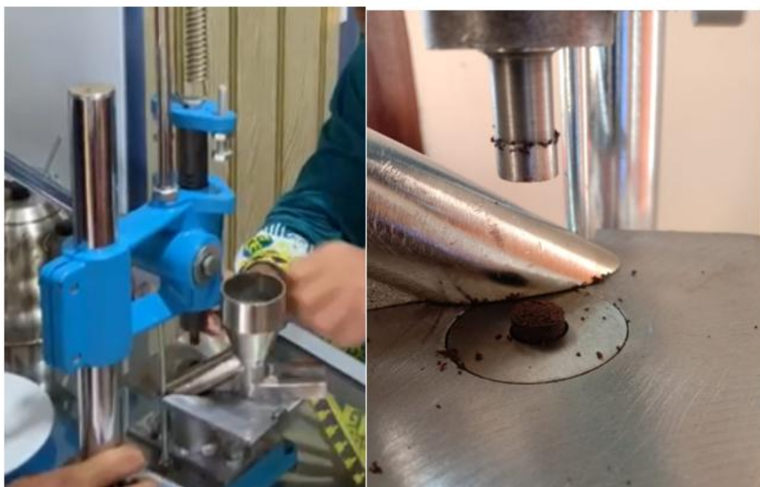
Gambar 5. Proses pencetakan kopi tablet dari cetakan dengan diangkat dan dipinggirkan
