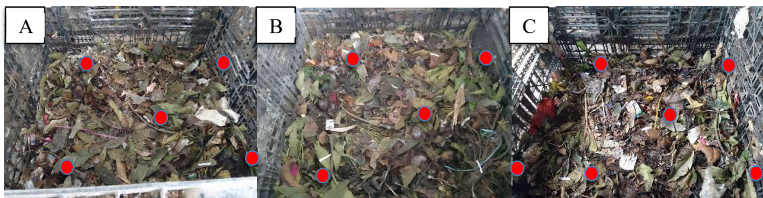
Gambar 1. Kotak uji biodrying dengan 5 titik pengukuran: (A) Talk; (B) Molase; (C) Formula Komersil IP
