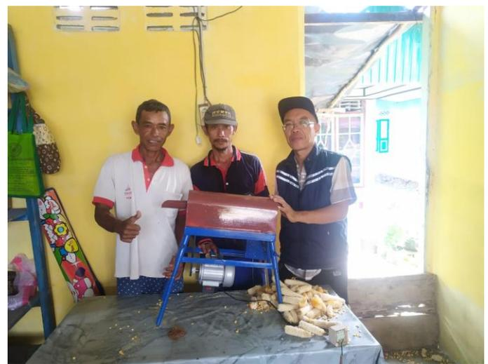
**Gambar 3.** Penyerahan mesin pemipil jagung daya 300 watt kapasitas 15 kg/jam kepada mitra kegiatan PPM
