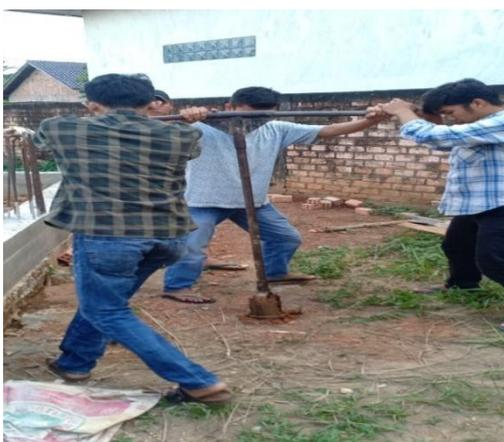
**Gambar 1.** Proses pengambilan sampel tanah
