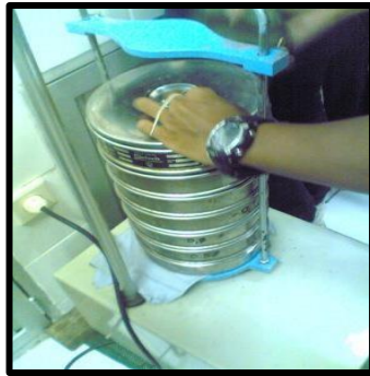
Gambar 2. Sieve Shaker dan Saringan
