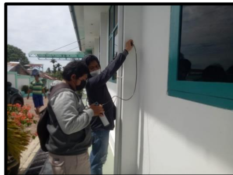
Gambar 18. Dokumentasi Pengujian UPV
