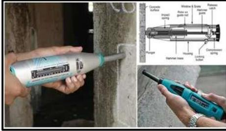
**Gambar 4.** Pengujian menggunakan alat *Rebound Hammer Test*
