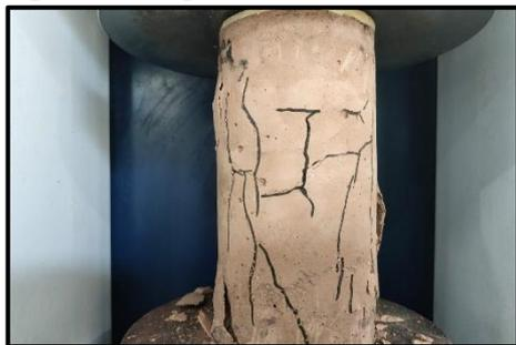
Gambar 12 Keretakan pada Beton Geopolimer saat Uji Kuat Tekan
