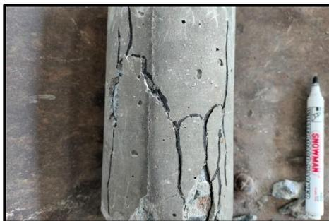
Gambar 6 Retak pada Beton Normal setelah Uji Kuat Tekan
