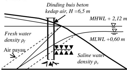
Gambar 3. Sket Letak Model Pengambilan Kombinasi Buis Beton dan Pipa Berpori
