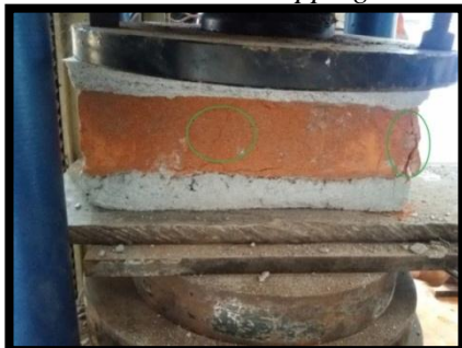
Gambar 7. Pola Retakan Pengujian Kuat Tekan Bata
