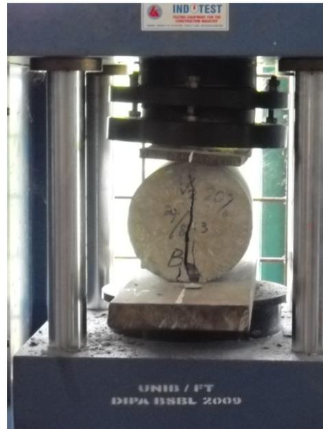
**Gambar 6.** Pengujian kuat belah beton
