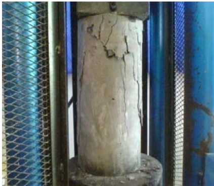
Gambar 1. Pengujian Kuat Tekan Beton
