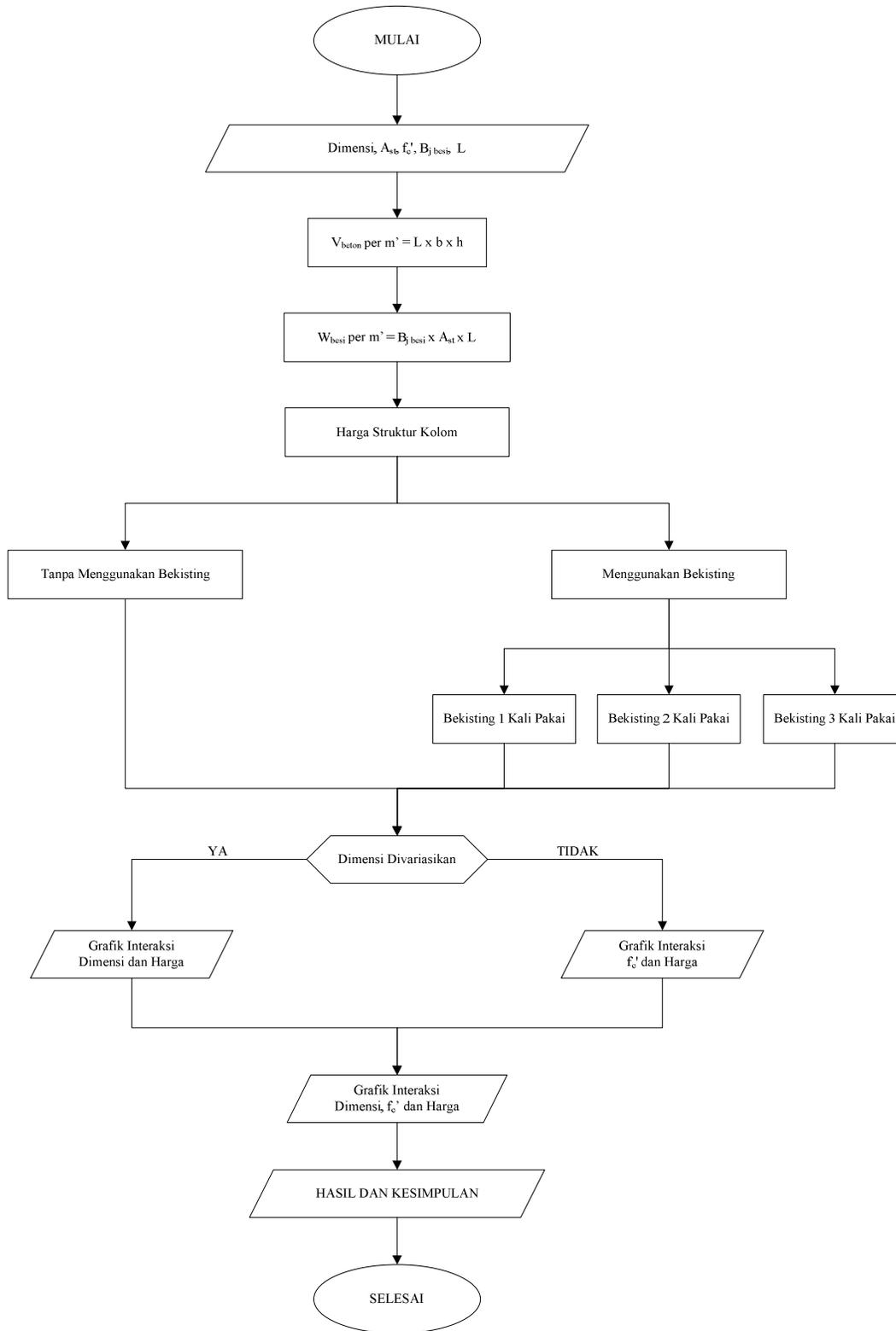
**Gambar 7.** Flowchart untuk Perbandingan Harga Kolom
