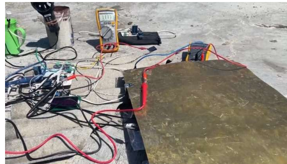
Gambar 4. Rangkaian Hybrid Sel Surya dan Thermoelectric Generator (TEG) tanpa beban
