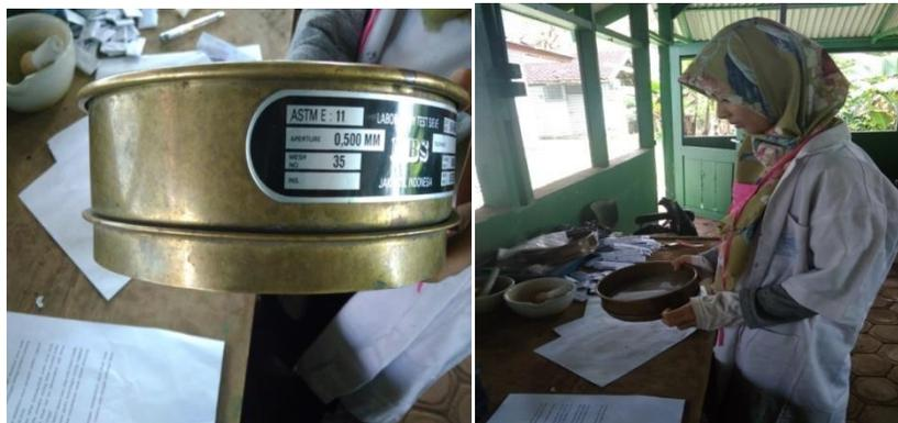
Gambar 14. Penyaringan bubuk bambu
