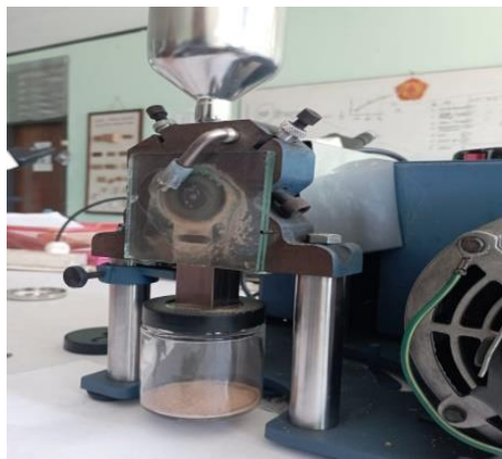
Gambar 5. Proses penghalusan sampel menggunakan grinder
