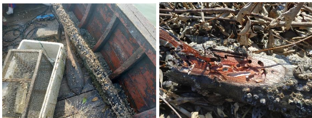
Gambar 1. Kayu yang diserang cacing penggerek kayu laut di hutan mangrove Setapok Besar Kota Singkawang Provinsi Kalimantan Barat
