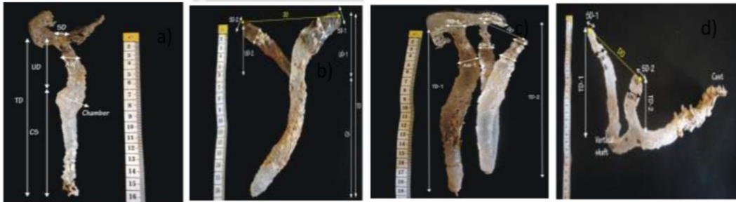
Gambar 4. Bentuk cetakan liang kepiting, a) Single, b) Y-shaped, c) U-shaped dan d). Kompeks (Sunaryo, 2012)
