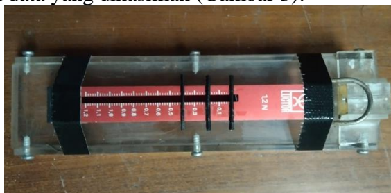
Gambar 3. Neraca pegas di atas benda yang telah diberi kawat acuan pada skala 0 N, 0,2 N, dan 0,4 N
