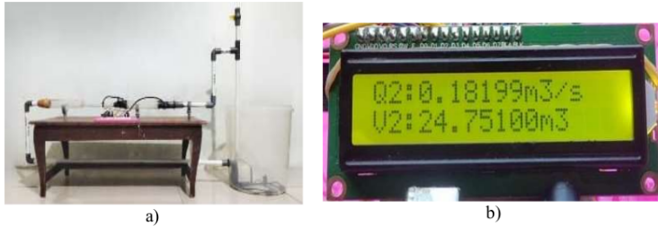
Gambar 7. a) Prototipe Alat Peraga Asas Bernoulli, b) Tampilan LCD
