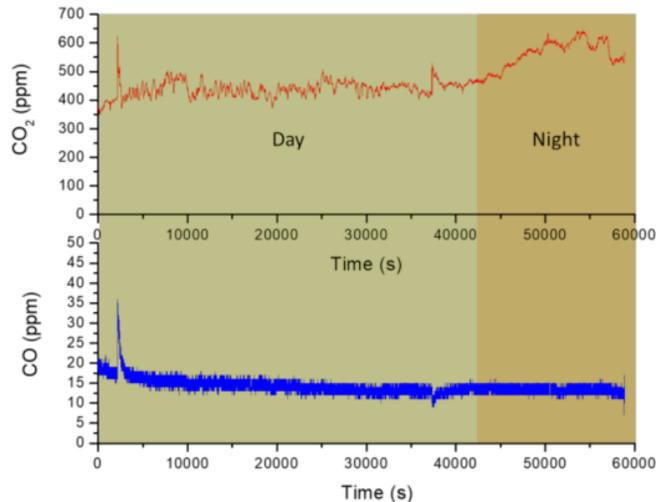
Gambar 4. Data hasil monitoring konsentrasi gas CO<sub>2</sub> dan gas CO pada siang dan malam hari
