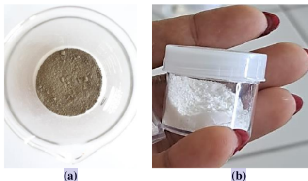
Gambar 1. Sampel (a) serbuk batuan vulkanik dan (b) serbuk silika (SiO 2 ) hasil ekstraksi.
