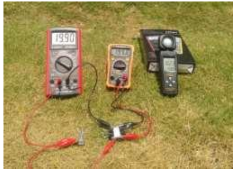
Gambar 2. Proses pengujian arus dan tegangan dari DSSC dengan multimeter Digital
