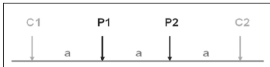
Gambar 2. Rangkaian Elektroda Konfigurasi Wenner Alpha [13]
