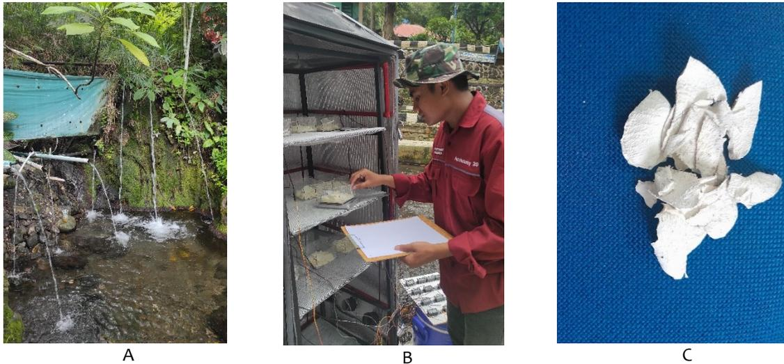
**Gambar 4.** A) Potensi sumber aliran air panas *geothermal* di Suban Curup, B) Proses pengambilan data pada alat pengering, C) Hasil pengeringan sangat baik (putih bersih dan hygienis)
