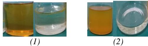
Gambar 1. Fraksi (1) minyak cair hasil pirolisis sampah plastik polietilen tereftalat (PET), (2) minyak cair hasil pirolisis sampah plastik PET berlapis logam (*metallized PET foil*)
