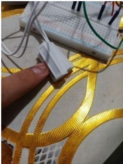
Gbr 14. Kondisi sensor magnet menempel
