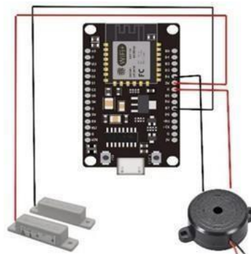
Gbr 6. Wiring perangkat
