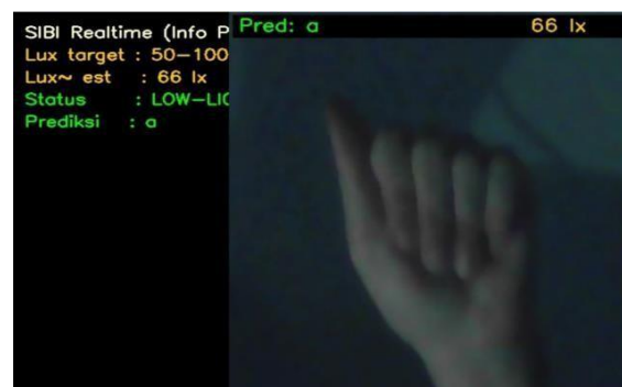
Gbr. 6. Antarmuka prototipe pengujian real-time huruf SIBI pada kondisi low-light
