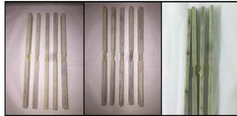
**Gambar 8.** Bentuk patahan spesimen Uji Tekan
