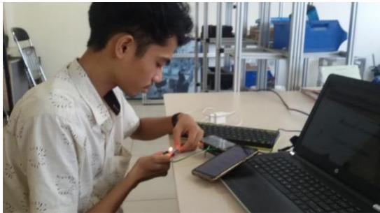
**Gambar 11.** Pengukuran Saat Sensor Didekatkan Dengan Sumber Panas
