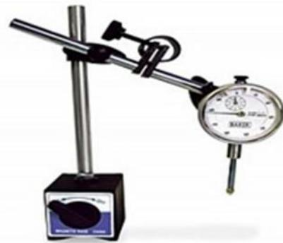
**Gambar 7.** Dial indikator yang dipasang pada *magnetic base* [7].
