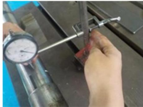
Gambar 11. Pengukuran Run-out.
