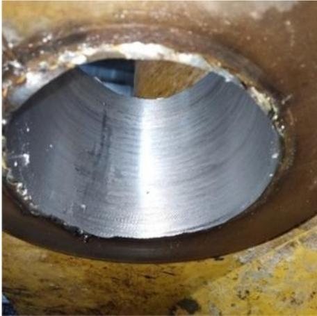
**Gambar 3.** Hasil pengeboran dengan kecepatan 20 Rpm
