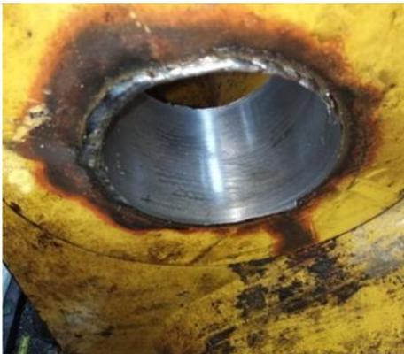
**Gambar 4.** Hasil pengeboran dengan kecepatan 31,5 Rpm
