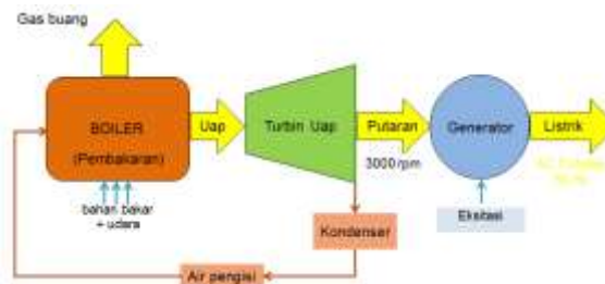
Gambar 1. Proses Konversi Energi Pada PLTU Sumber : (Anonim,2024)
