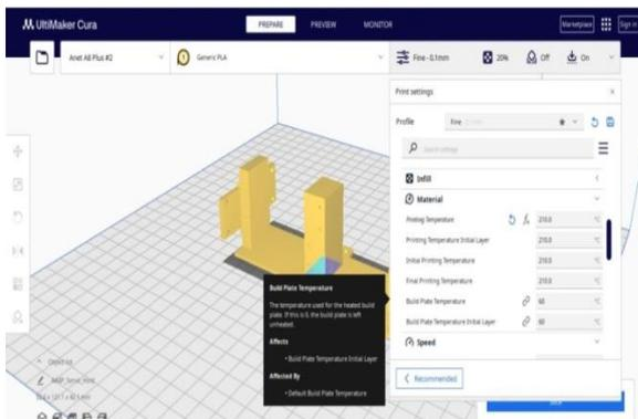
**Gambar 2.** Mengatur Suhu Saat Proses Percetakan
