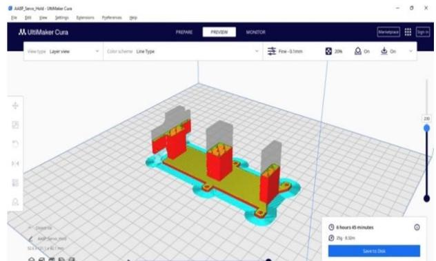
**Gambar 31.** Melakukan Slice pada desain
