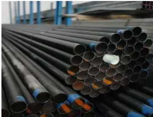
Gambar 1. Pipa Besi, digunakan sebagai kerangka utama kursi transfer
