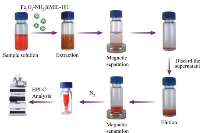
**Gambar 1.** Metode MSPE untuk pewarna Sudan menggunakan  $\text{Fe}_3\text{O}_4\text{-NH}_2\text{@MIL-101}$  [12]
