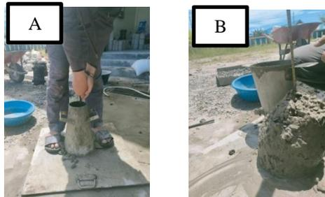
Gambar 7. (A) Proses pengujian nilai *slump* dan (B) Proses perhitungan nilai *slump*
