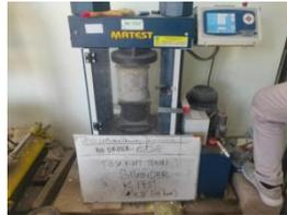
Gambar 9. Proses pengujian kuat tekan beton
