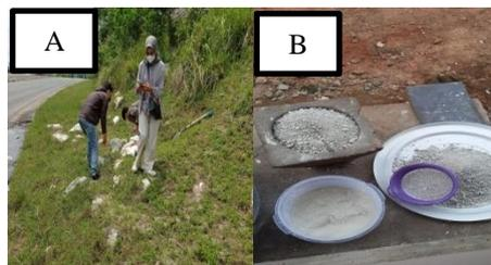
Gambar 2. (A) Pengambilan sampel zeolit dan (B) Proses penghalusan zeolit
