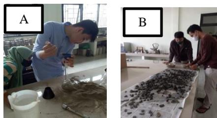
Gambar 5. (A) Proses analisis berat jenis agregat halus dan (B) proses analisis berat jenis agregat kasar
