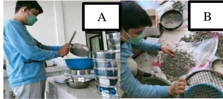
Gambar 3. (A) Proses analisis saringan agregat halus dan (B) Proses analisis saringan agregat kasar
