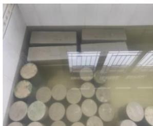
Gambar 8. Proses perendaman beton sebelum diuji
