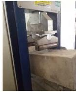
Gambar 11. Proses pengujian kuat lentur beton
