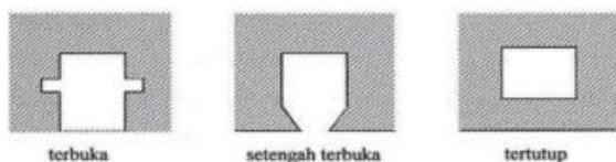
**Gambar 2.** Bentuk-bentuk Alur Stator
