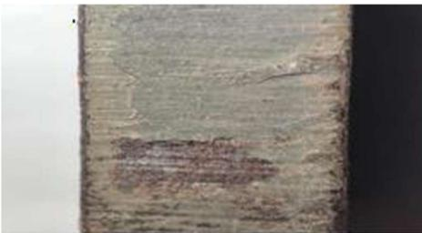
**Gambar 8. Spesimen yang Telah Dilakukan Perendaman 120 Jam**
