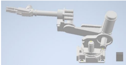
Gambar 5. Hasil 3D Produk Lengan Robot 6 DOF Pemosisian
